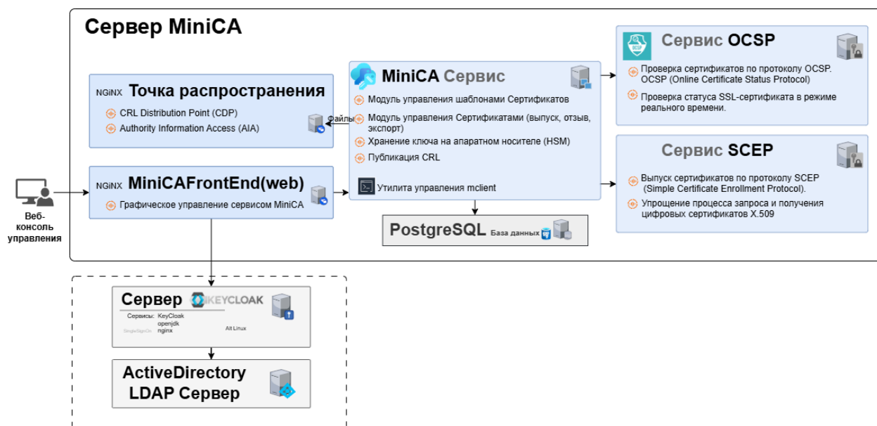
Рисунок 5 — Базовая схема физической архитектуры MiniCA на одном сервере
